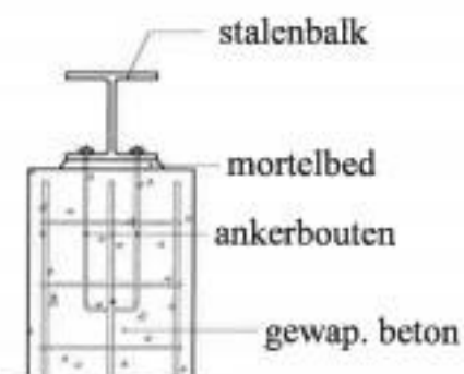
DETAIL OPLEGGING EN VERANKERING STALEN BALKEN
